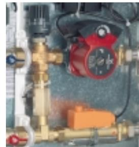
Рис. Регулятор температуры с накладным датчиком, теплопроводным цоколем, энергосберегающим циркуляционным насосом 15/60 со встроенным электронным устройством регулирования мощности
